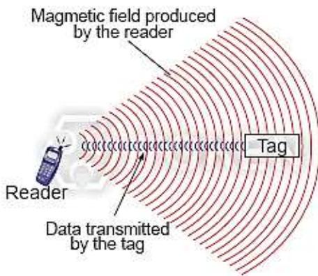
**Figure 1. RFID System**
